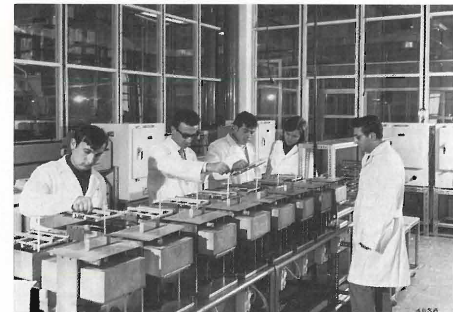
Fig. 3 - Bagni per il deposito del nitrato di manganese sugli anodi di tantalio ossidato (FACE Standard di Maddaloni).
