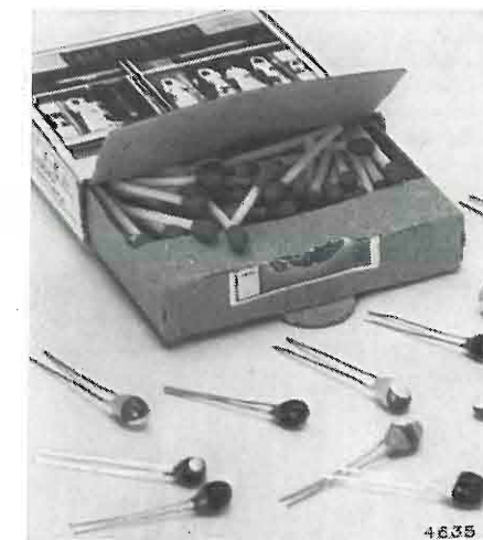
Fig. 2. — Aspetto e dimensioni dei normali condensatori al tantalio.
